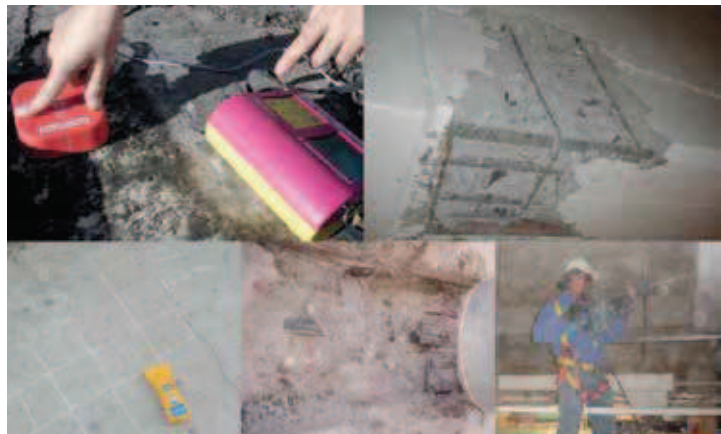
F.6 Pachómetros para detectar armaduras y cateos para observación directa
